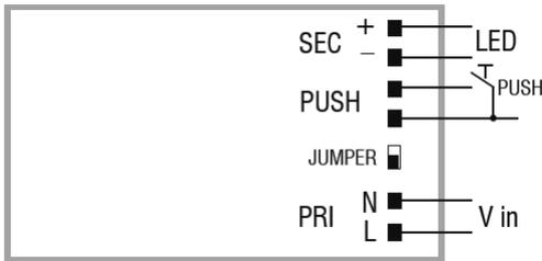
ESQUEMA CONEXIÓN PUSH MÚLTIPLE CONALUX 12-40W:
