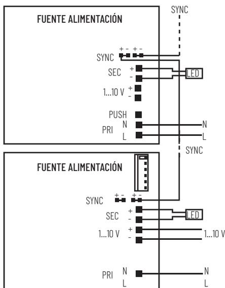
ESQUEMA CONEXIÓN PUSH 6W:
